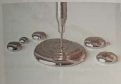
Živo srebro tvori kapljice, ki pobegnejo, če se mu približamo s kakšnim predmetom.
